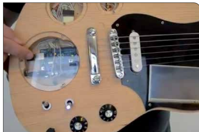
Mit Arduino-, Bewegungssensor-, Bluetooth- und Touchpad-Technologie wurde eine selbstgebaute E-Gitarre modifiziert, um mittels unterschiedlicher Bewegungen Effektmodulatoren anzusteuern. (Autor: Marcel Freyer)
